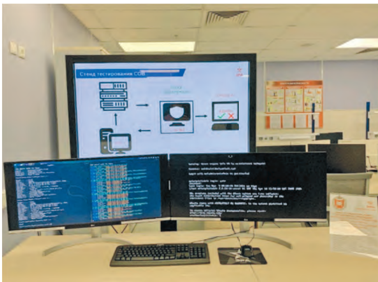
Рис. 2. Стенд тестирования систем аудита информационной безопасности
